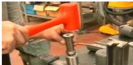
بلبرینگ را روی محور روتور قرار داده سپس با ابزار
