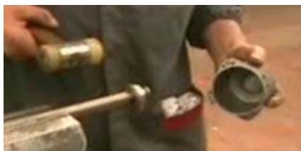
نحوه جدا شدن بلبرینگ از انتهای پوسته موتور
