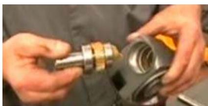
با ضربه زدن توسط چکش پلاستیکی به بدنه موتور
