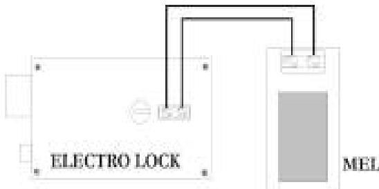
برای استفاده از قفل الکترونیکی لازم است که پارامترهای P 0 و P 1 به SI تغییر کنند. در صورت استفاده از کارت MEL و انجام تغییر پارامترهای مربوط به آن، در پایان هر بار کارکرد جک ها، درست بعد از کاهش یافتن سرعت موتورها و بسته شدن کامل درب ها، موتورها دوباره برای مدت مربوط به پارامتر  $t_C$  (از صفر الی ۲.۵ ثانیه) به کار با سرعت معمولی ادامه می دهند. در حقیقت این کار جهت فشار نهایی به درب ها برای بستن قفل فنری آن می باشد.
