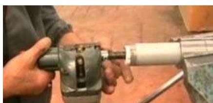
پیچ مربوط به اتصال گیربکس موتور و میله مارپیچ را
