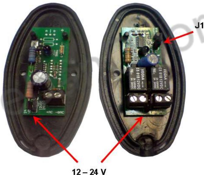
فتوسلها می توانند در دو مد بسته و باز سیم بندی شوند، که مد بسته کاربرد بیشتری دارد. در مد باز با هر بار دیدن مانع، توقف در کار کرد پیش می آید اما در مد بسته در حالت بستن شدن درها، با دیدن مانع بلا فاصله درها باز شده و توقفی نخواهند داشت.
