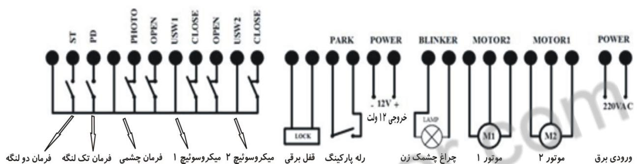
موتور ۱ و موتور ۲ از نوع ۲۲۰ ولت میباشند.
